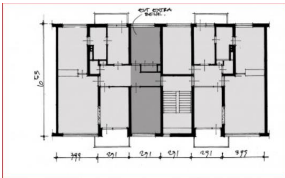
Afbeelding 17. Prontobouwsysteem portieketagewoningen. Bron Liebrechts, 2012
